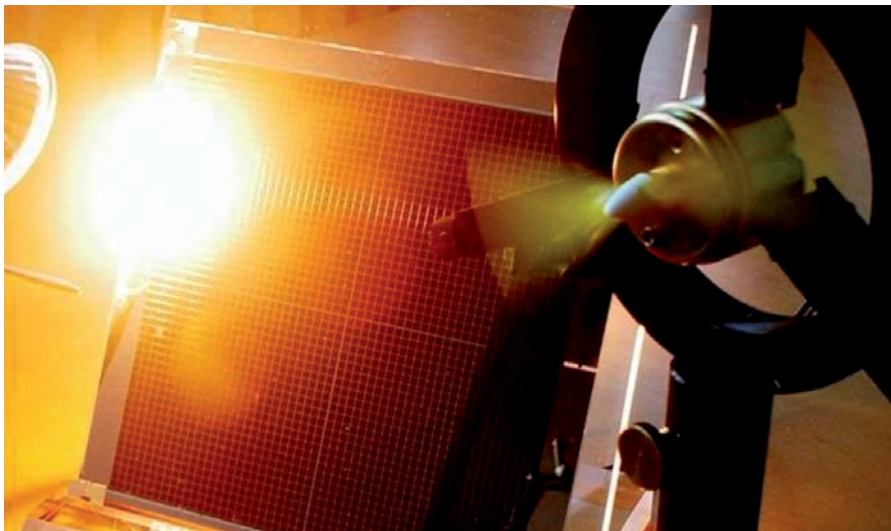
ABB. 5: Organische Solarzellen von Heliatak GmbH betreiben einen Ventilator.
