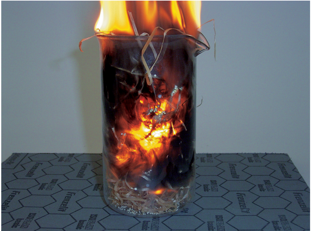
Abb. 1 Becherglas mit brennender Holzwolle und Natriumperoxid
