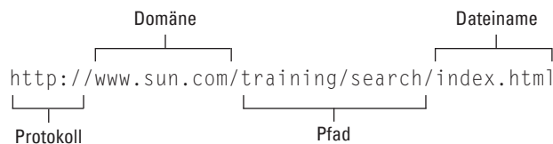
Abbildung 1.3: Die Komponenten eines URL identifizieren die genaue Position einer einzelnen Datei im Web.
