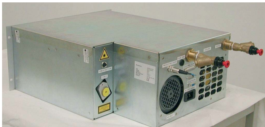
Die OEM-Pumpmodule der LDM-Serie sind besonders leicht integrierbar: 350 W aus der 400 µm Faser (NA 0,2) bei 976 nm oder bei 940 +/- 3 nm. (Quelle: Laserline)
