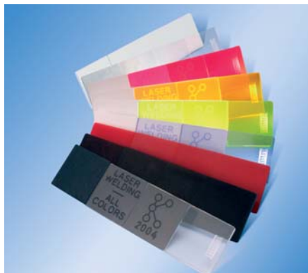
ABBILDUNG 3: Mit Hilfe von Lumogen IR-Farbstoffen kann die komplette farbige Komplexitätspalette beim Laserkunststoffschweißen realisiert werden.
