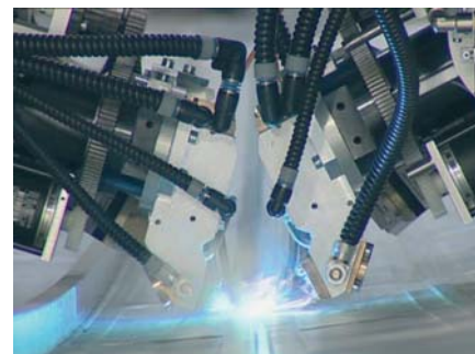
ABBILDUNG 3: Synchroner Doppel-3D-Nahtführung für beidseitig gleichzeitiges Laserstrahlschweißen. (Quelle: Fraunhofer IWS Dresden)
