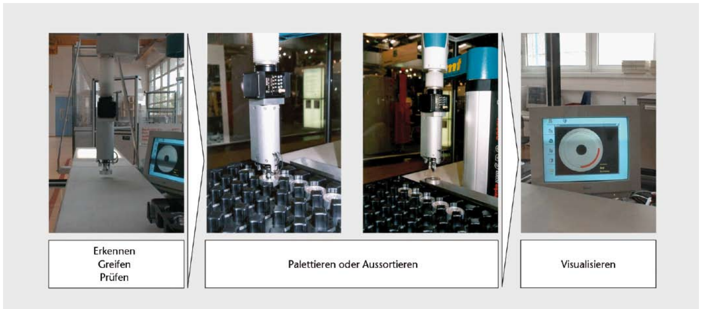
ABB. 4: Arbeitsprozesse der Pilotanlage zur Oberflächenkontaminationskontrolle.
