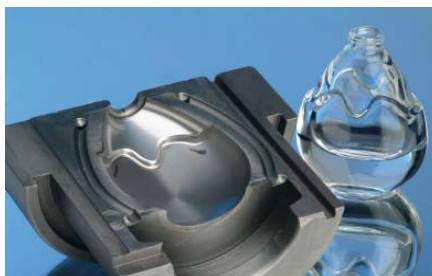
Metallene Form für die Glasherstellung, der obere Teil ist laserpoliert.
