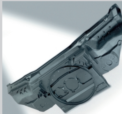
Im Rahmen des Vorhabens entwickeltes anwendungsnahes Demonstratorbauteil (Frontend/Vorderwand BMW Group)
